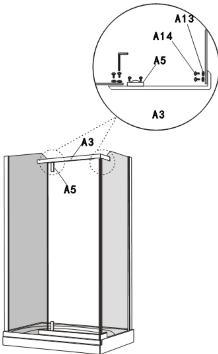
**2.3. Соединение задних стенок:**
